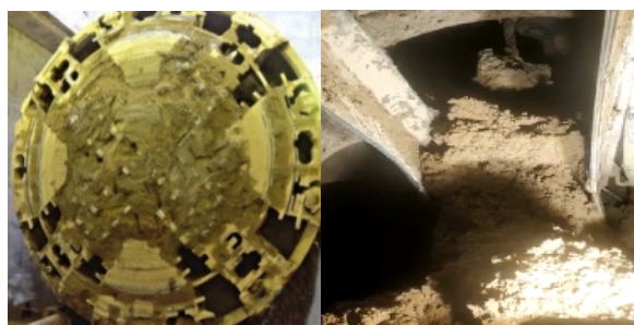
图 1 盾构刀盘结泥饼及堵塞情况 [8-9]
